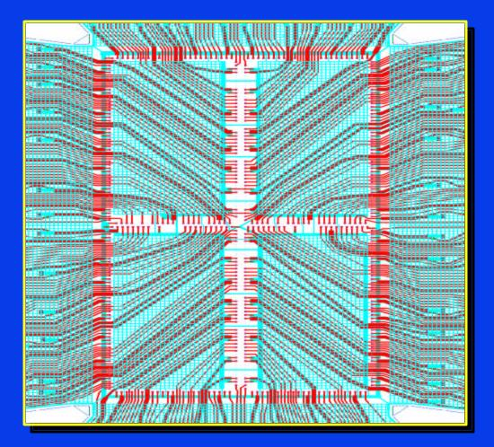
• 2 x 2 **FSRAM** array • Max. die size -44.2mm • 1040 l/Os
